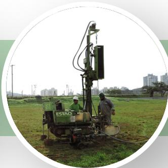
Equipamentos mecanizados sobre esteira para sondagem.
