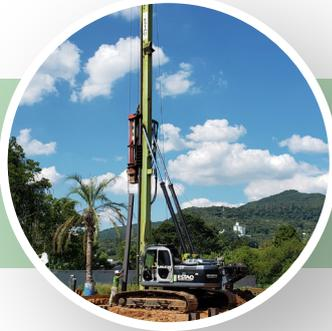
Martelo Hidráulico para cravação de estacas.
